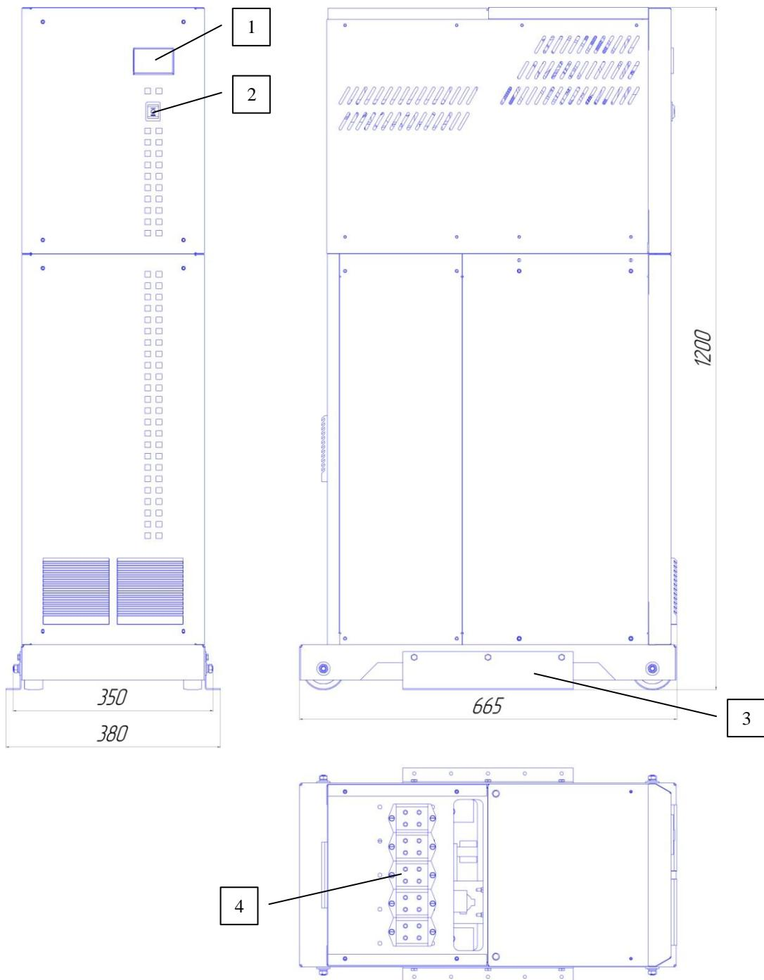
Рис.2. Внешний вид блока: 1 – индикаторная панель; 2 – переключатель режимов работы стабилизатора «ЧЕРЕЗ СТАБИЛИЗАТОР» - «ОТКЛ. НАГР.» - «ПРЯМОЕ ВКЛЮЧЕНИЕ»; 3 – кронштейны для фиксации стабилизатора при транспортировании и на месте монтажа; 4 – клеммная колодка для подключения стабилизатора.
