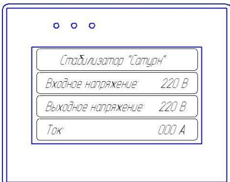
2.3.3.1.2. Если выходное напряжение превышает значения, указанные в таблице 1, то нагрузка отключается и в нижней строке высвечивается надпись «отключен по напряжению». При нормализации выходного напряжения система переходит в рабочее состояние автоматически.
