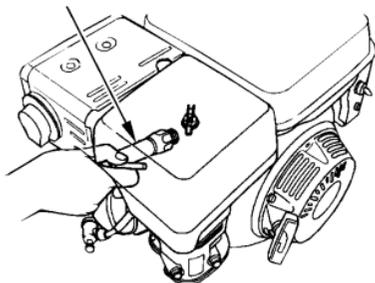
Для замены свечей зажигания снимите колпачок (см. Рис.14), наденьте свечной ключ на свечу зажигания и выкрутите ее против часовой стрелки. Вкрутите по часовой стрелке новую свечу до упора от руки и проверните ее на четверть оборота свечным ключом. Наденьте колпачок на свечу.
